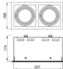
**Einbauleuchte mit Wechselreflektorsystem**
