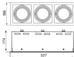
**Einbauleuchte mit Wechselreflektorsystem**
