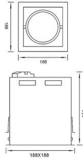
**Einbauleuchte mit Wechselreflektorsystem**
